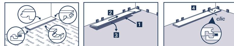
Ismételje meg ugyanezt az eljárást a falig, ahol a pallót átjelöléses módszerrel fogja levágni.
