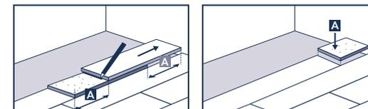
Aby zainstalować następny rząd, należy umieścić pióro fragmentu panelu (obciętego z poprzedniego rzędu) o długości co najmniej 30 cm we wpuszczenie poprzedniego rzędu pod kątem około 30°, a następnie złożyć do poziomu i lekko docisnąć. Pióro kolejnego panelu włóż również pod kątem 30° do wpustu panelu w poprzedniego rzędu, możliwie najdokładniej wyrównaj panel z końcem poprzedniego panelu w tym samym rzędzie i zatrzaśnij go zgodnie z opisem powyżej.
