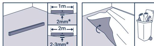
metalljoonlaua korral 3 mm ja alla 1 m korral 2 mm. Tekstiil- ja nõelviltpõrandakatted tuleb eemaldada. Põhimõtteliselt on soovitatav eemaldada kõik põrandakatted.
