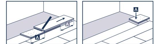
Para instalar a fila seguinte, posicione o painel restante com pelo menos 30 cm de comprimento na ranhura longitudinal da fila já instalada, a um ângulo de aproximadamente 30°, e assente-o na fila anterior fazendo uma leve pressão. Pegue no painel seguinte, coloque-o também a um ângulo de aproximadamente 30° no sentido longitudinal do painel da primeira fila já instalada, alinhe-o o mais perto possível com a extremidade do painel anteriormente instalado e fixe-o como descrito acima.
