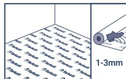
Posez la première lame avec le côté languette face au mur, puis posez toutes les autres lames de la même façon, de droite à gauche. Assurez-vous que les extrémités soient posées les unes sur les autres, de façon à ce que les rainures et les languettes correspondent parfaitement, et verrouillez-les en appuyant/tapant d'un petit coup de maillet en caoutchouc.
