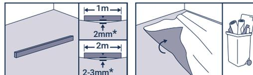
A tolerância máxima de nivelamento é de 3 mm sob régua de metal de 2 m e de 2 mm sob 1 m. Os revestimentos de piso têxteis e de feltro agulhado devem ser removidos. Recomenda-se que todos os revestimentos do pavimento existentes sejam removidos por princípio.
