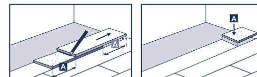
Za postavljanje sljedećeg reda postavite preostalu ploču duljine najmanje 30 cm u uzdužni utor već postavljenog reda pod kutom od približno 30° i spustite je laganim pritiskom u prethodni red. Uzmite sljedeću ploču i također je postavite pod kutom od oko 30° u uzdužnom smjeru na već postavljenu ploču prvog reda, poravnajte što bliže kraju prethodno postavljene ploče i blokirajte je kako je ranije opisano.
