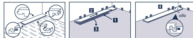
Postup opakujte, dokud nedojdete k protější stěně. Zde lamelu zkraťte podle linie, kterou si předtím narýsujete.
