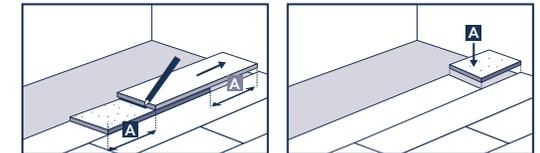
Pentru a monta rândul următor, așezați panoul rămas (care are o lungime de cel puțin 30 cm) la un unghi de aproximativ 30° în nutul longitudinal al rândului deja montat și coborâți-l în rândul anterior printr-o apăsare ușoară. Luați următorul panou, așezați-l și pe acesta într-un unghi de aproximativ 30° pe direcția longitudinală a panoului din primul rând deja montat, aliniați-l cât mai aproape posibil de capătul panoului montat anterior și fixați-l conform descrierii de mai sus.
