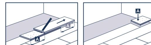
Při pokládce druhé řady umístěte zbytek zkrácené lamely (dlouhý minimálně 30 cm) do podélné drážky již položené řady, a to pod úhlem přibližně 30°. Mírným tlakem lamelu sklopte dolů do předchozí řady. Také další panel umístěte pod úhlem cca 30° v podélném směru k panelu v první položené řadě. Zarovnejte ho co nejbliž ke konci předchozího položeného panelu a zacvakněte ho podle pokynů výše.
