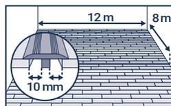
E méretek felett tágulási profilt kell alkalmazni. A szegélylécek, burkolatváltó profilok vagy végprofilok lerakásakor a szegélyléceket vagy a profilokat sohasem szabad a padlóburkolathoz rögzíteni.
