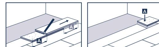
A következő sor lefektetéséhez helyezze a legalább 30 cm hosszú maradék panelt a már lefektetett sor hosszanti hornyába kb. 30°-os szögben, majd enyhe nyomással engedje be az előző sorba. Vegye elő a következő panelt, és helyezze azt szintén kb. 30°-os szögben hosszirányban az első már lerakott sor paneljére, igazítsa a lehető legszorosabban a korábban lefektetett panel végéhez, és rögzítse a fent leírtak szerint.
