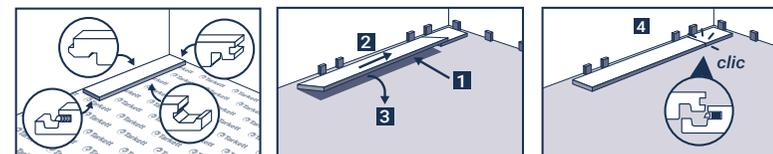
Rovnaký postup zopakujte až po stenu, kde budete dosku rezať pomocou rysovacej metódy.
