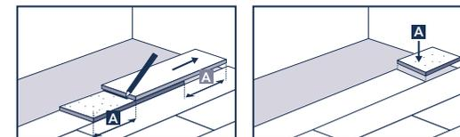
Järgmise rea paigaldamiseks asetage vasakpoolne vähemalt 30 cm pikkune laud juba paigaldatud rea pikisoonde umbes 30° nurga all ja langetage see kergelt surudes eelmise rea külge. Võtke järgmine paneel ja asetage see ka umbes 30° nurga all juba paigaldatud esimese rea paneeli suhtes pikisuunas, joondage see võimalikult tihedalt varem paigaldatud paneeli otsaga ja lukustage, nagu on eespool kirjeldatud.
