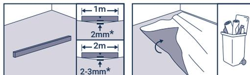
Maksymalna tolerancja nierówności wynosi 3 mm na długości 2 m oraz 2 mm na długości poniżej 1 m. Wykładziny tekstylne i filcowe muszą zostać usunięte. Zasadniczo doradzamy usunięcie wszelkich pokryć podłogowych.
