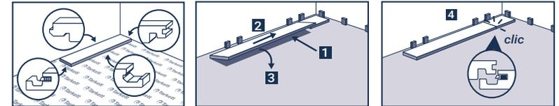
Repita o mesmo processo até à parede onde irá cortar a régua por riscagem.
