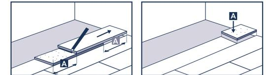
Lai ieklātu nākamo rindu, atlikušo paneli, kas ir vismaz 30 cm garš, 30 grādu leņķī ieāķē ieklātās rindas paneļa gropē un, nedaudz uzspiežot, ieklāj līdzās iepriekšējai rindai. Nākamo paneli atkal apmēram 30 grādu leņķī ieāķē gareniskā virzienā jau ieklātajā panelī tā, lai gals būtu apmēram vienā līmenī ar ieklāto paneli, un saslēdz tos kā aprakstīts iepriekš.
