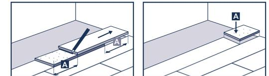
Pour poser le rang suivant, posez la lame restante d'au moins 30 cm de longueur sur la rainure du rang déjà posé à un angle d'environ 30°, et faites-le glisser en exerçant une pression légère sur la rangée précédente. Prenez la lame suivante, posez-la également avec un angle de 30° environ dans le sens de la longueur, sur celle déjà posée du premier rang, amenez-la aussi près que possible de la lame posée précédemment et verrouillez-la comme décrit ci-dessus.
