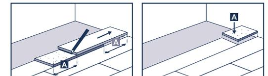
Za vgradnjo naslednje vrste položite preostalo ploščo dolžine vsaj 30 cm v vzdolžni utor že nameščene vrste pod kotom približno 30° in jo z rahlim pritiskom spustite v prejšnjo vrsto. Vzemite naslednjo ploščo, jo postavite tudi pod kotom približno 30° v vzdolžni smeri na ploščo že nameščene prve vrste, jo poravnajte čim bližje koncu prej nameščene plošče in jo pritrdite, kot je opisano zgoraj.
