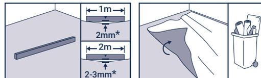
planeitate este de 3 mm sub rigla metalică de 2 m și de 2 mm sub 1 m. Se vor scoate mochetele din material textil și din pâslă. În principiu, se recomandă ca toate mochetele să fie îndepărtate.
