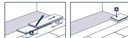
Per la posa della fila successiva, posare un pannello di almeno 30 cm di lunghezza nella scanalatura longitudinale della fila già posata a un angolo di circa 30° e farlo scivolare nella fila precedente esercitando una leggera pressione. Prendere la doga successiva, posizionarla a un angolo di circa 30° in senso longitudinale sulla doga già posata della prima fila. Allinearla il più vicino possibile all'estremità della doga posata in precedenza e fissarla come descritto sopra.
