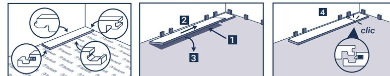
Ponovite isti postupak do zida na kojem ćete prerezati dasku sastavljanjem.
