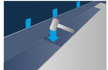
Este método se utiliza luego para instalar todas las demás filas. Asegúrese de que las juntas de los extremos estén desplazadas al menos 30 cm en las filas individuales para lograr la mejor instalación. Para instalar la última fila, se mide la distancia entre la pared y la fila instalada y se transfiere al panel. La última fila instalada debe tener la mitad del ancho de un panel que sea posible.
