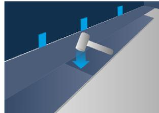
Questo metodo viene utilizzato per installare tutte le file. Accertarsi che i giunti delle doghe poste alla fine di ciascuna fila siano sfalsati di almeno 30cm. Per installare l'ultima fila, la distanza tra il muro e la fila già installata deve essere misurata e trasferita ad ogni doga da installare. L'ultima fila installata deve avere una larghezza il più vicino possibile a quella di mezza doga. Ricorda uno spazio di dilatazione minimo di 6mm.
