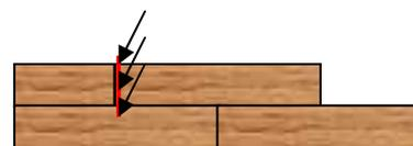
3- Abaisser le panneau d'un seul mouvement en exerçant une légère pression au niveau du joint de tête. S'assurer que durant ce mouvement, les panneaux reste bien accolés, et qu'aucun espace n'apparait
