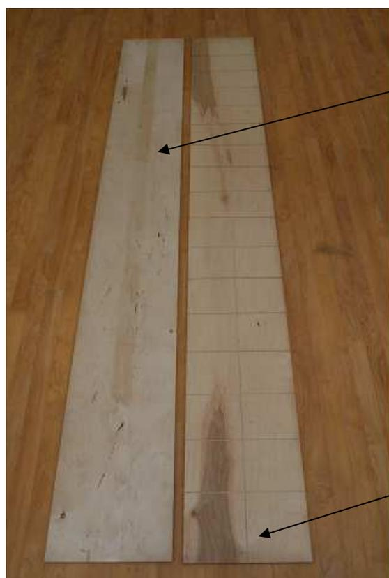
L'endroit du panneau Tarflex avec le défoncement devant recevoir la colle Targlue
