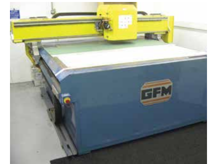
4 Het snijprogramma wordt doorgestuurd naar onze sonische snijmachine.
