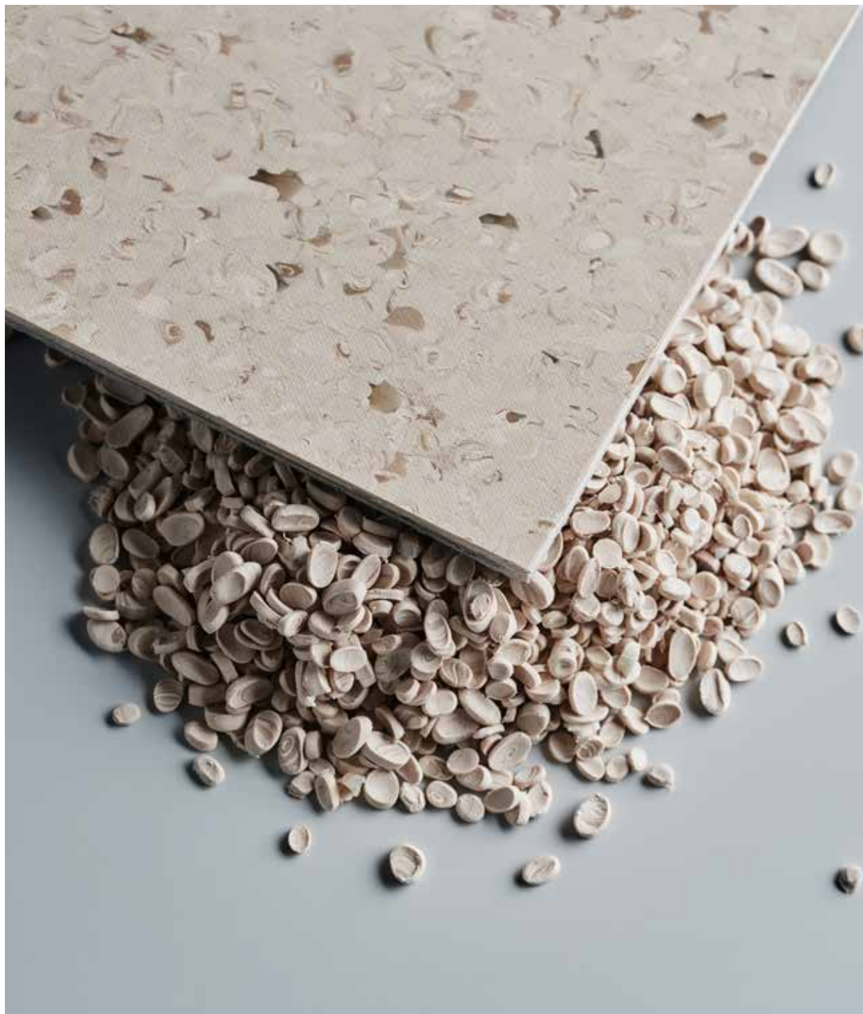
Échantillon de revêtement de sol en vinyle homogène et granulés recyclés
