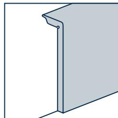
Weißer, hochdichter Polystyrol-Schaumstoff, 100% recycelbar, mit Schutzlackierung.
